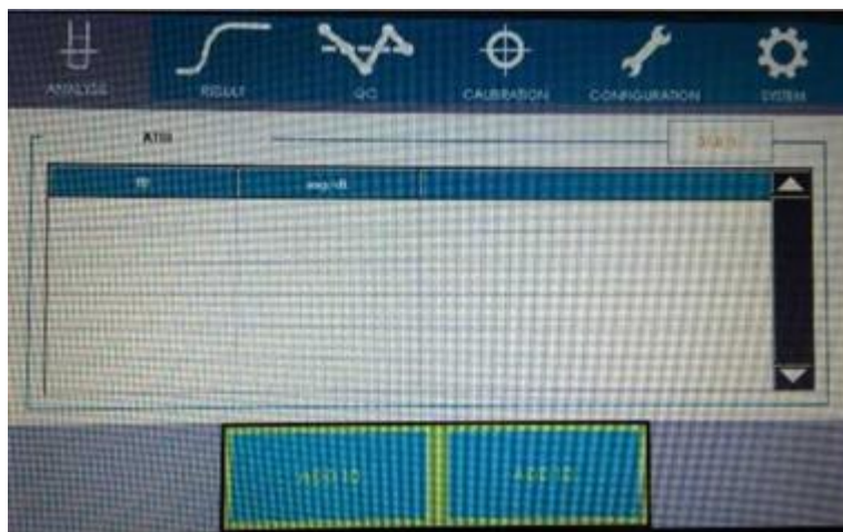
Рисунок 12 Экран «Анализ» для хромогенных проб (Прогрессивный антитромбин III), настроенный для запуска в параллельном режиме
